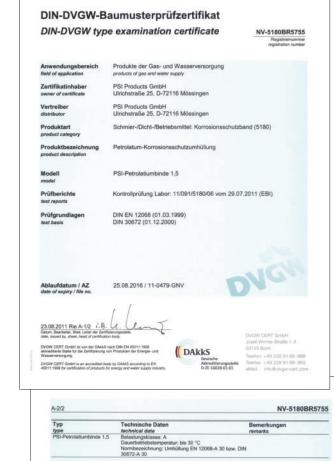
Verwendungshinweise / Bemerkungen hints of utilization / remarks Verarbeitung: kait zu verarbeitendes Korrosionsschutzband, Wicklung mit 50 % Überlappung (2 Lagen)
