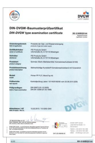
Typ Technische Daten type technical data technical data Primer FP P 27; MonoTop 40 Belastungsklasse: B Dauerbetriebstemperatur: max. +30 °C
